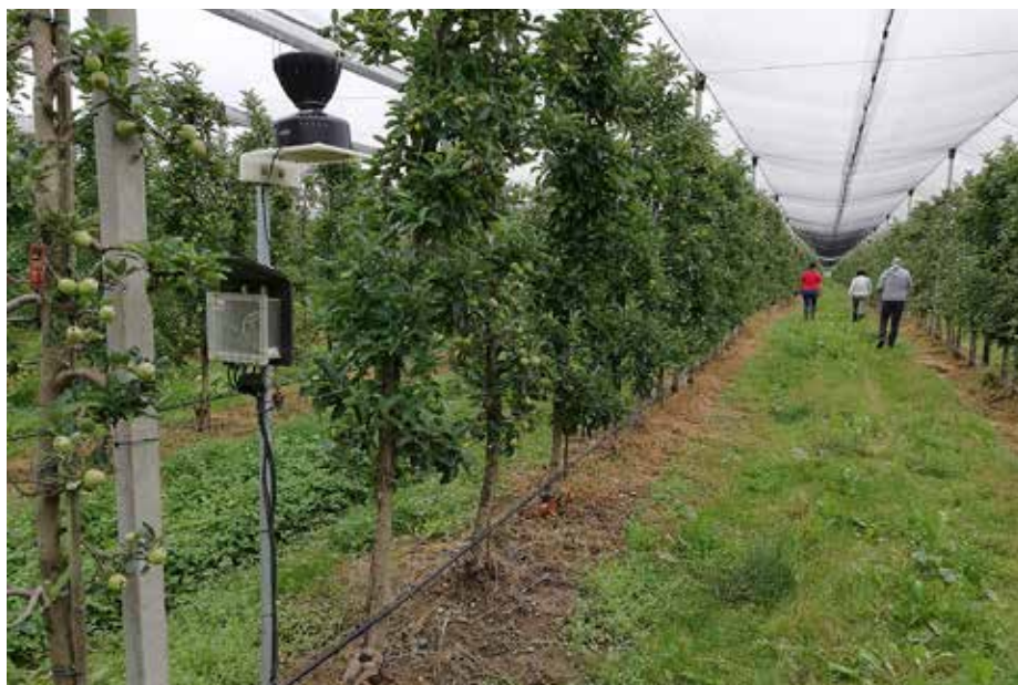
Slika 4: Nadzemni del sistema za merjenje vsebnosti vode v tleh in strokovna podpora za pomoč na terenu pri uporabi SPON.
