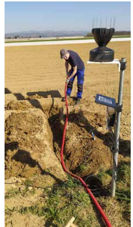
Slika 4: Delo na terenu za vzpostavitev sistema SPON. Odvzem vzorcev, vgradnja merilnikov vsebnosti vode v tleh in povezava merilnikov s komunikacijsko napravo.
