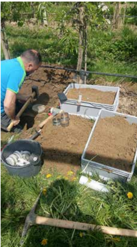
Slika 4: Delo na terenu za vzpostavitev sistema SPON. Odvzem vzorcev, vgradnja merilnikov vsebnosti vode v tleh in povezava merilnikov s komunikacijsko napravo.
