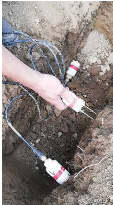
Slika 4: Delo na terenu za vzpostavitev sistema SPON. Odvzem vzorcev, vgradnja merilnikov vsebnosti vode v tleh in povezava merilnikov s komunikacijsko napravo.
