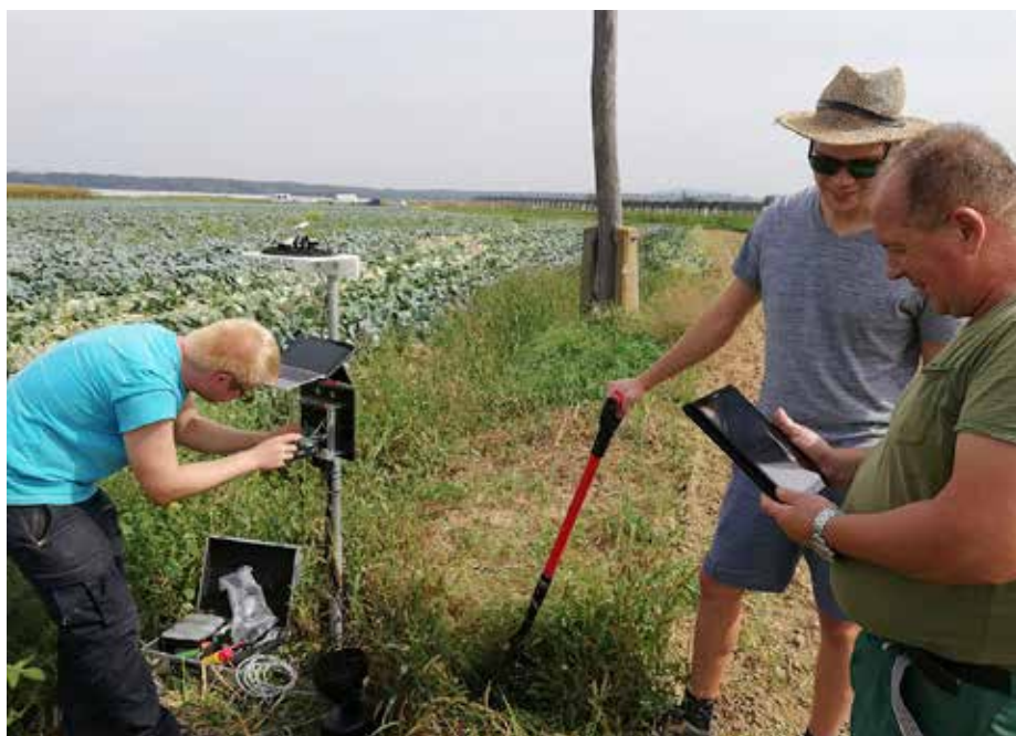
Slika 4: Nadzemni del sistema za merjenje vsebnosti vode v tleh in strokovna podpora za pomoč na terenu pri uporabi SPON.
