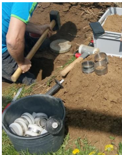
Slika 18: Delo na terenu za vzpostavitev sistema SPON. Odvzem vzorcev, vgradnja merilnikov vsebnosti vode v tleh in povezava merilnikov z komunikacijsko napravo.
