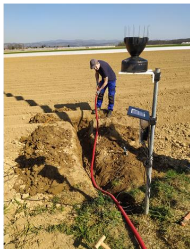
Slika 18: Delo na terenu za vzpostavitev sistema SPON. Odvzem vzorcev, vgradnja merilnikov vsebnosti vode v tleh in povezava merilnikov z komunikacijsko napravo.
