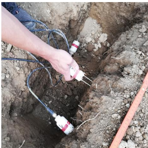
Slika 18: Delo na terenu za vzpostavitev sistema SPON. Odvzem vzorcev, vgradnja merilnikov vsebnosti vode v tleh in povezava merilnikov z komunikacijsko napravo.
