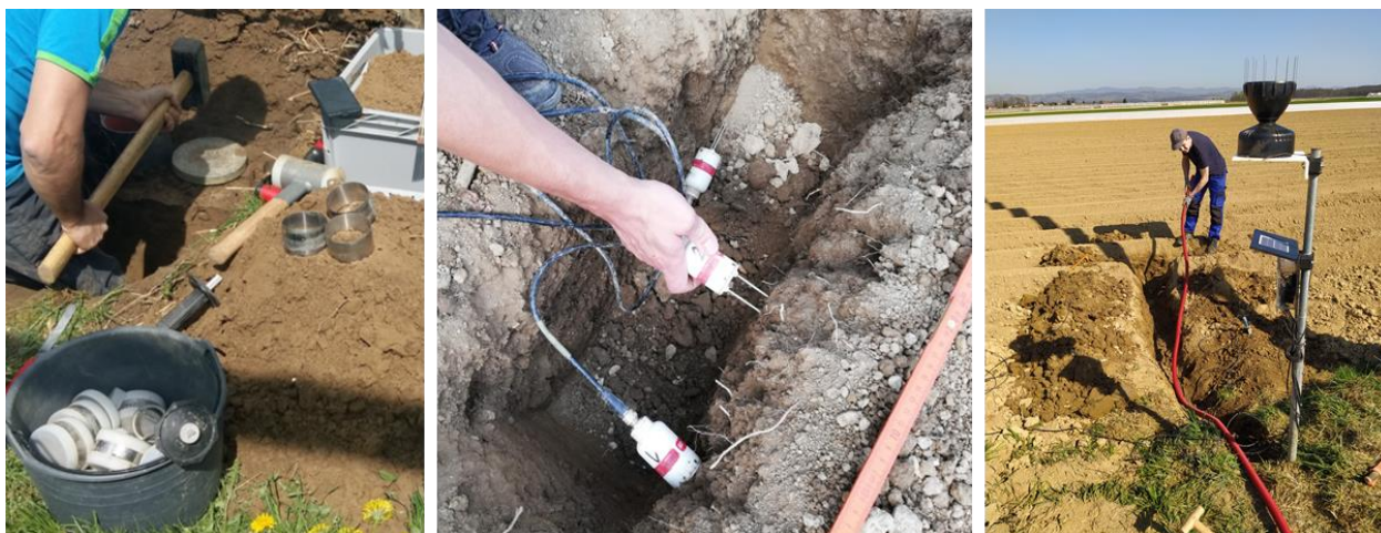
Slika 2. Delo na terenu za vzpostavitev sistema SPON. Odvzem vzorcev, vgradnja merilnikov vsebnosti vode v tleh in povezava merilnikov s komunikacijsko napravo.
