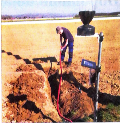
Slika 4: Delo na terenu za vzpostavitev sistema SPON. Odzveti v zrcelci, vgradnja merilnikov vsebnosti vode v tleh in povezava merilnikov s komunikacijsko napravo.
