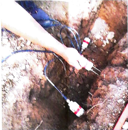
Slika 4: Delo na terenu za vzpostavitev sistema SPON. Odzveti v zrcelci, vgradnja merilnikov vsebnosti vode v tleh in povezava merilnikov s komunikacijsko napravo.
