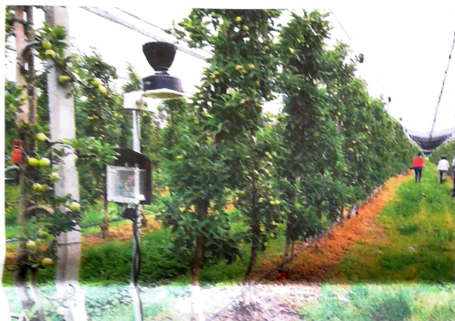
Slika 5: Nadzorni del sistema za merjenje vsebnosti vode v tleh (zgoraj) in strokovna podpora za pomoč na terenu pri uporabi SPON (spodaj).
