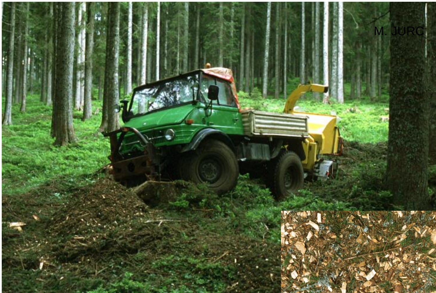
Sanacija žarišča - mletje sečnih ostankov s strojem Lignatec Chromcom M110, Pokljuka, 1999
