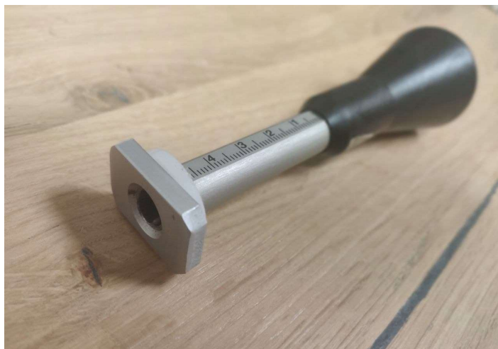
Naprava za merjenje debeline skorje (Foto: L. Krajnc).
