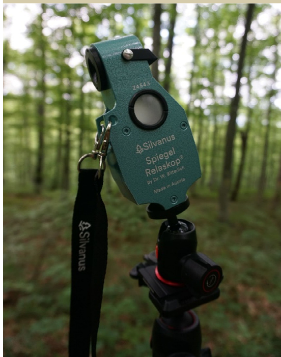
Inštrument za optično merjenje premerov debel nad prsno višino (Foto: L. Krajnc).
