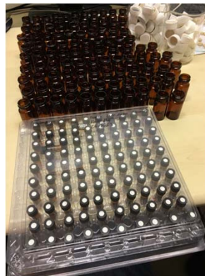
Slika 1: Ekstrakte bele jelke ( Abies alba Mill.) smo pred HPLC analizo prefiltrirali skozi poliamidni filter v temne vialle. Vzorec je bil nato direktno injiciran na zanko HPLC sistema (foto V. Vek).
