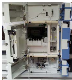
Slika 2: Ločba ekstraktivov lesa bele jelke je potekala na Thermo Fischer Accela sistemu za tekočinsko kromatografijo visoke ločljivosti (HPLC). Modularni sistem tvorijo termostatisiran avtomatski vzorčevalnik, kvarterna 600 barska črpalka, termostatisirana komora s kolono ter fotodiodni PDA detektor (foto V. Vek).
