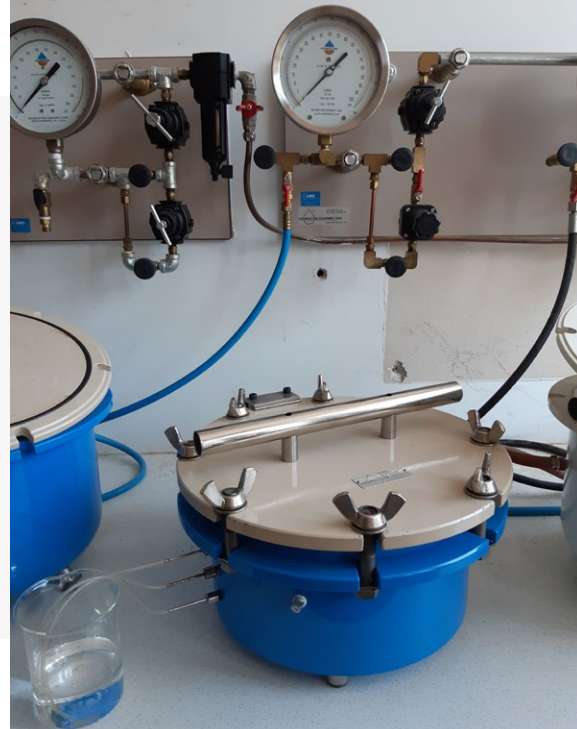
Slika 15: Laboratorijske analize vodozadrževalnih lastnosti tal. HYPROP (str. 12) in Richardova tlačna komora (desno).
