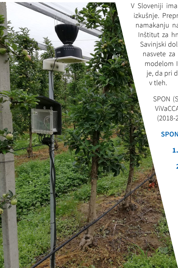
Slika 2: Nadzemni del sistema za merjenje vsebnosti vode v tleh.
