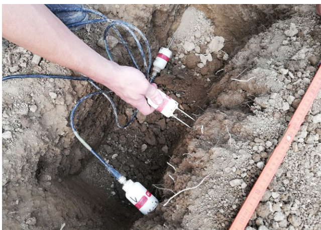
Slika 25: Vgradnja merilnikov vsebnosti vode v tleh.
