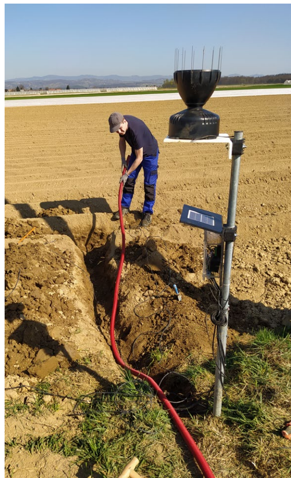
Slika 24: Delo na terenu za vzpostavitev sistema SPON: povezava merilnikov s komunikacijsko napravo.
