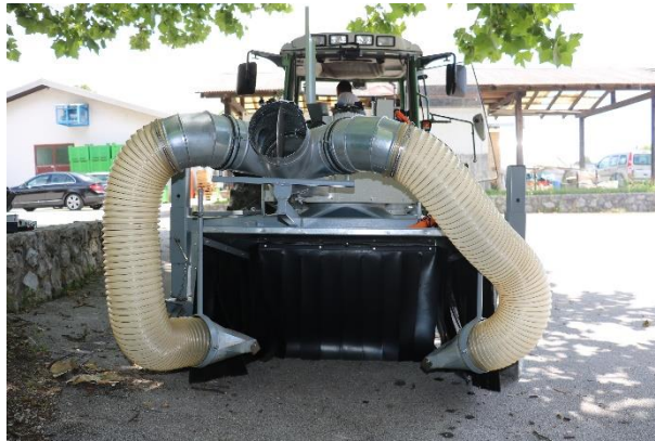
Slika 22: Frontalni del traktorskega sesalnika za žuželke (foto: S. Trdan).
