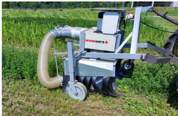
Slika 23: Podporno kolo sesalnika služi prilagajanju delovne višine stroja razvojni fazi posevka ob sesanju (foto: S. Trdan).
