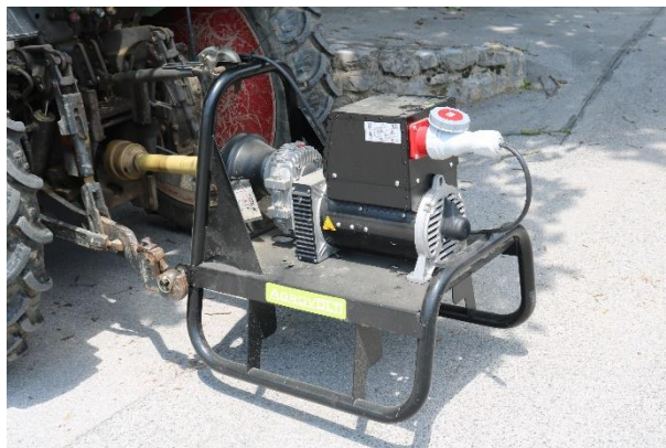
Slika 24: Generator na zadnjem delu traktorja (foto: S. Trdan)
