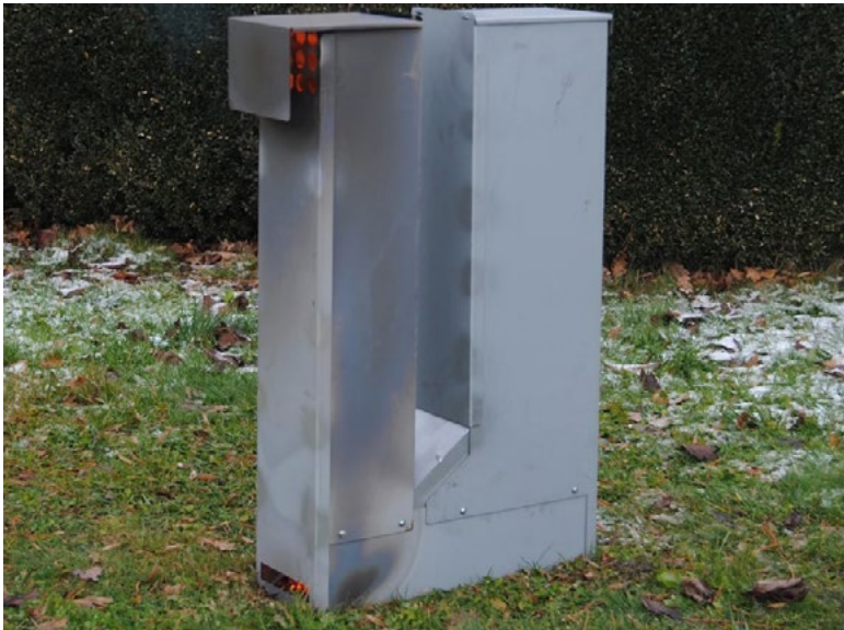
Slika 11: Peč za ogrevanje; za zaščito enega hektarja sadovnjaka potrebujemo od 200 do 400 peči
