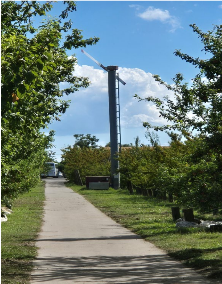
Slika 14: Vetrnica za mešanje hladnejšega zraka pri tleh s toplejšim zrakom višje
