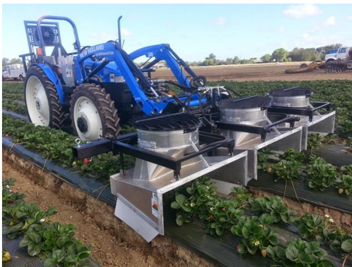
Slika 2: Novejši trivrstni sesalnik s hidrostatičnim pogonom.
