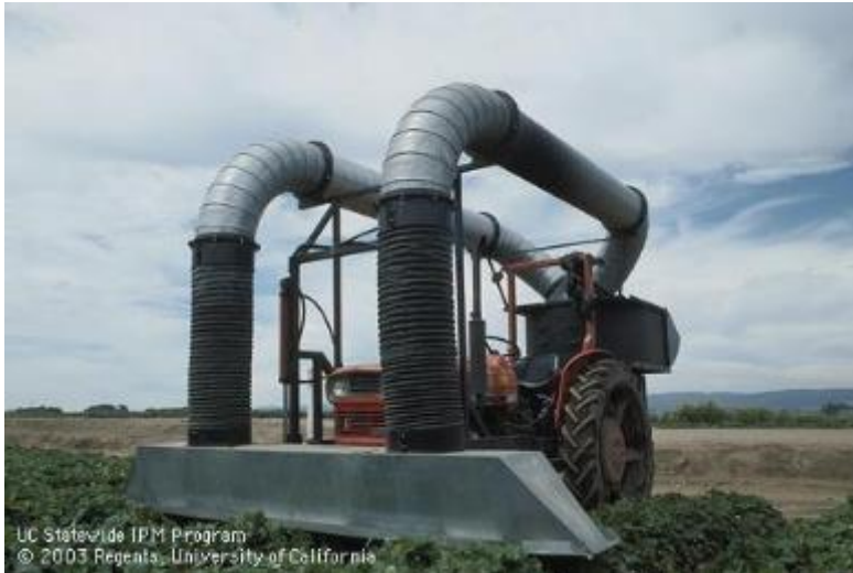
Slika 1: Starejša izvedba sesalnika, prigrajenega na traktor.
