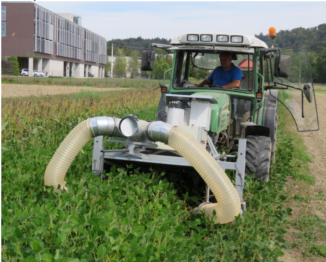
Slika: Frontalni del traktorskega sesalnika za žuželke.
