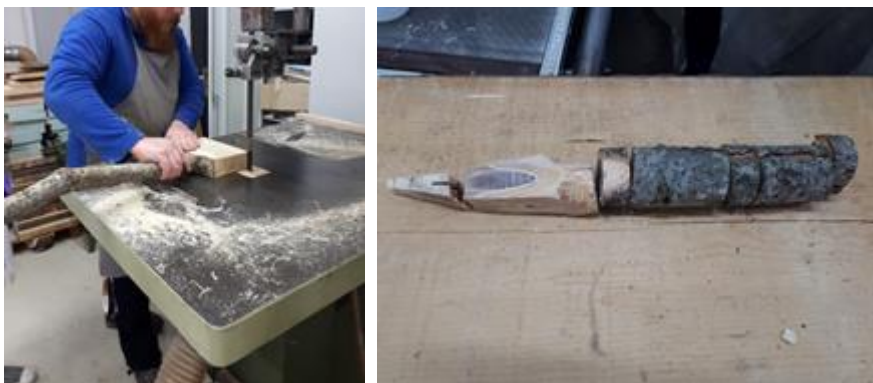
Slika 23: Vzorčne kolote debla bele jelke ( Abies alba Mill.) smo grobo razžagali s tračnim žagalnim strojem v delavnici Oddelka za lesarstvo Biotehniške fakultete. Iz jelovih kolotov smo izolirali več vzorcev lesa in skorje (foto V. Vek).
