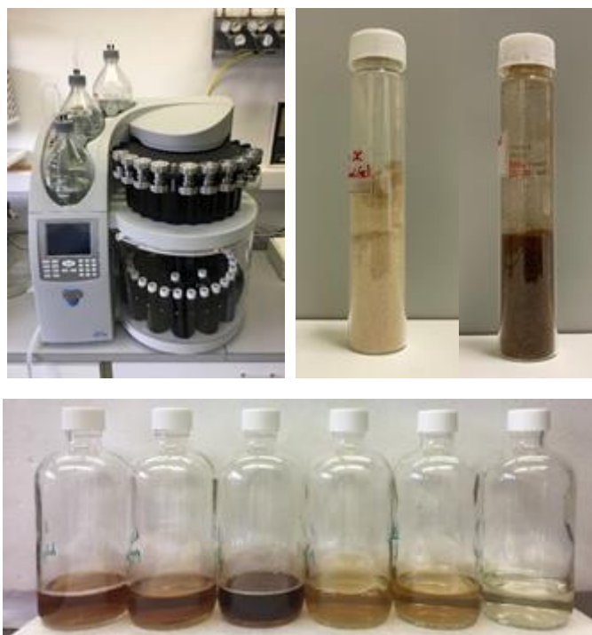
Slika 24: Ekstrakcija lesa in skorje bele jelke ( Abies alba Mill.) je potekala pri temperaturi nad vreliščem topila in nadtlaku v sistemu za pospešeno ekstrakcijo Thermo Scientific Dionex ASE 350. Vzorci lesa se nahajajo v ekstrakcijskih celicah v pladnju avtomatskega vzorčevalnika (zgornji del sistema). Po ekstrakciji se ekstrakt filtrira v zbiralne steklenice (spodnji del sistema). Vse ekstrakte smo liofilizacijsko posušili ( T = -85^{\circ}\text{C} , p < 0,050 mbar) in ustrezno shranili do pričetka bioloških testiranj (foto V. Vek).
