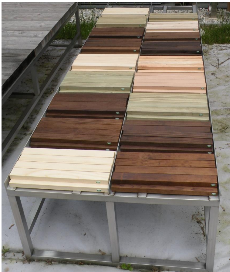
Slika 33: Izpostavitve vzorcev v skladu z dvoslojnim testom v Ljubljani
