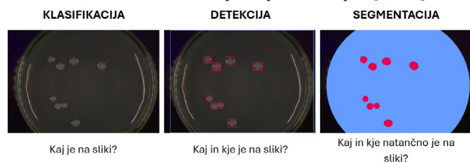
Slika 2: Grafična ponazoritev razlik med klasifikacijo, detekcijo in segmentacijo primerkov (rdeče – bakterijska kolonija; modro – petrijevka)
